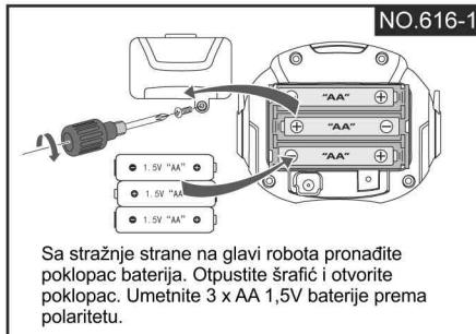
Sa stražnje strane na glavi robota pronađite poklopac baterija. Otpustite šrafić i otvorite poklopac. Umetnite 3 x AA 1,5V baterije prema polaritetu.
